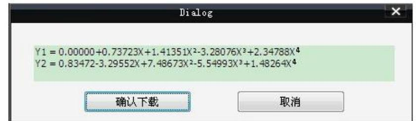
4 按下确认下载按钮，软件向密度计传输校准数据，完成校准后密度计视窗将显示 E. 3
